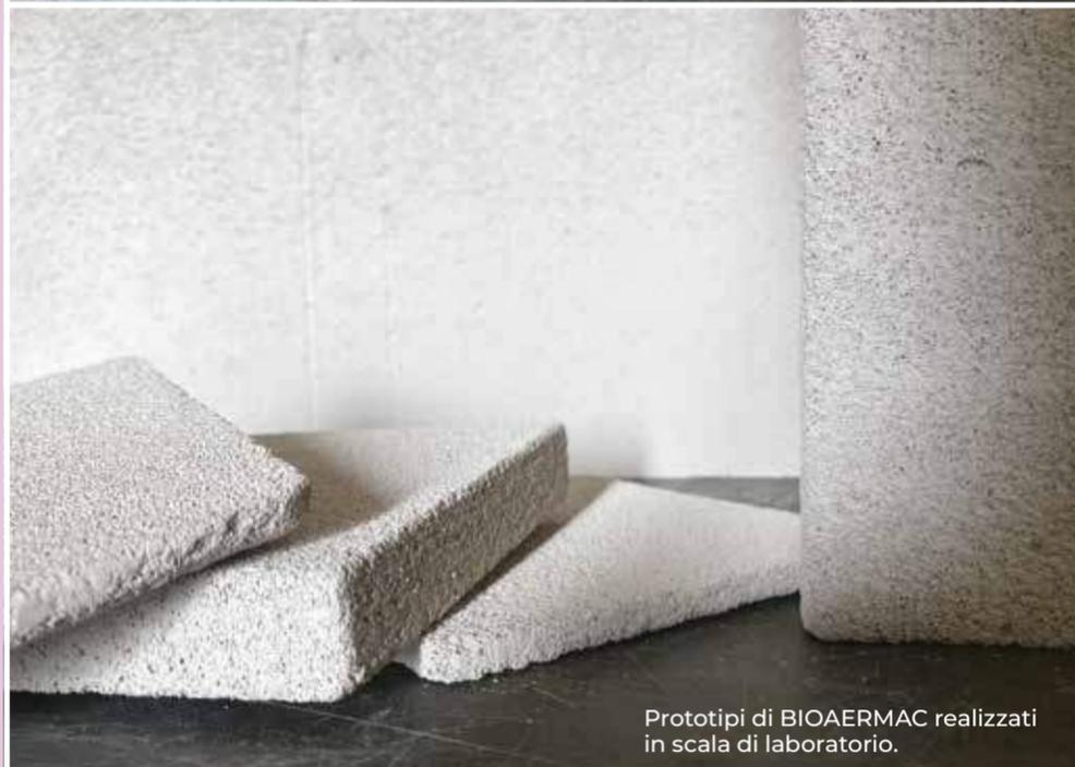
Prototipi di BIOAERMAC realizzati in scala di laboratorio.
