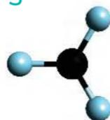
Il Fluoruro di Alluminio è una polvere bianca, utilizzata principalmente per la produzione di alluminio primario: riduce la temperatura e migliora la conduttività del bagno fuso, limitando il consumo di energia elettrica.
